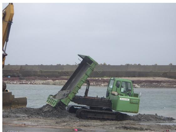
写真一7・8 水陸両用機材による応急復旧状況
