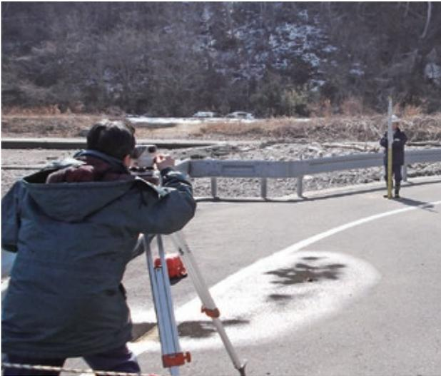
写真一七 状況写真及びレベル測量
