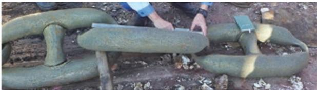
図4 回収した下部補強鎖中部の末端
