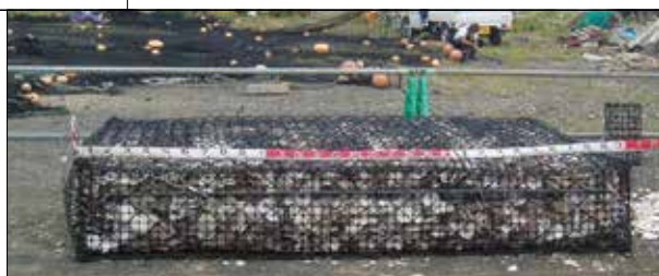
石かご礁（通水管付）中詰材：はたて貝殻 L・Lマリンマット φ7.0mm×100mm（網目）0.5×2.0×3.0 8点吊 中詰め材に貝殻を使用、生息生物により水質浄化
