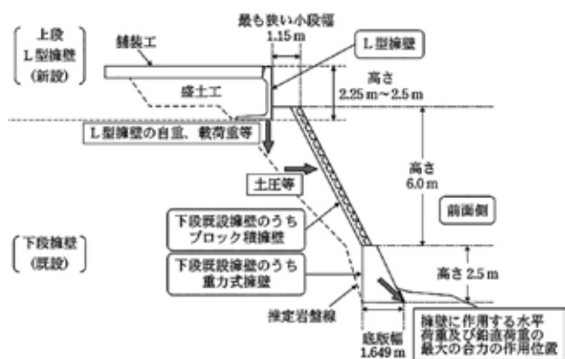
参考図1 各擁壁の断面図(概念図)
