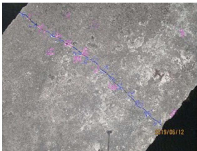
図-5 ひび割れ線の画像pixel表示
