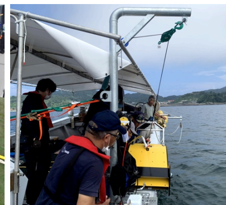
写真2 曳航体の海中への潜航作業状況
