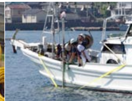
写真2 曳航体の艀装状況(側舷に固定)
