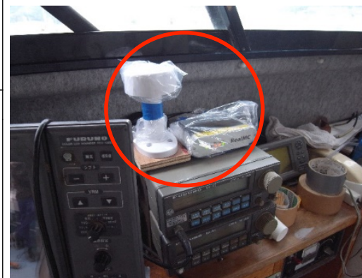
写真1 漁船キャビン内のGPSデータローガー
