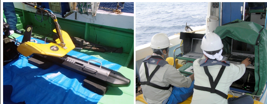
写真1 System4000曳航体 (沈降翼装着時)
