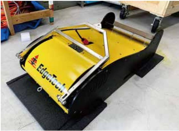
写真-9 海底地層探査機 (サブボトムプロファイラー)
