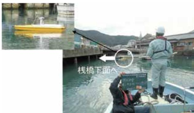
写真-1 棧橋下面の計測状況（左上：無線小型船舶）
