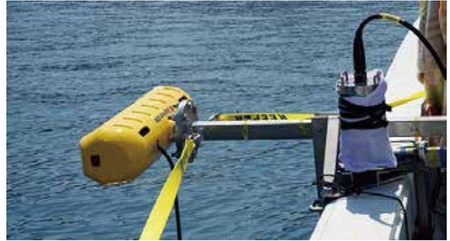
写真-8 最新型インターフェロメトリ音響測深機
