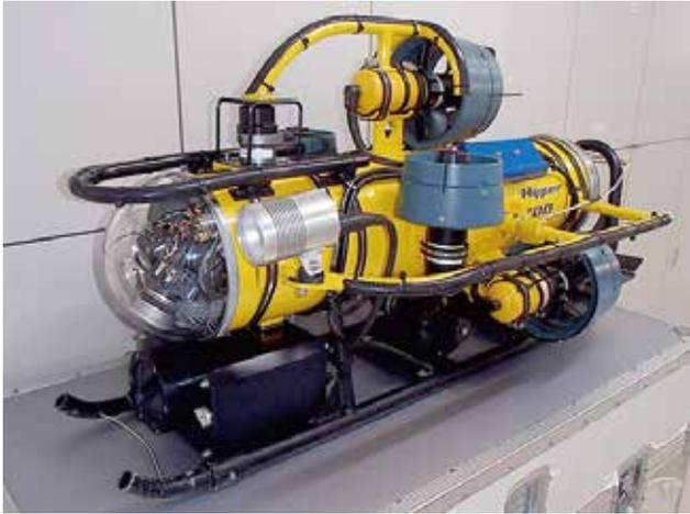
写真-6 ROV（小型有索式水中ロボット）
